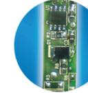
IC 電子溫控 43°C 恆溫控制
